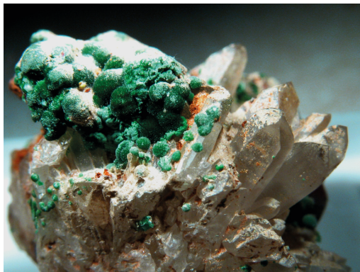
Figura 6: Malachite su quarzo (Foto Bonotti, 2010). Si noti come i cristalli di quarzo presentano tracce di una patina grigiastra che all'analisi diffrattometrica si è rivelata un miscuglio di cerussite, anglesite e dolomite. Dimensione media dei globuli di malachite 1,5 mm.
