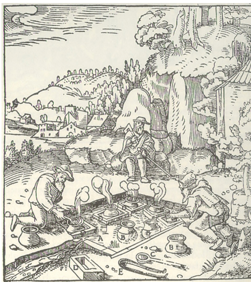
Figura 3: De Re Metallica: Uso del calore naturale per l'estrazione del "Nitro Volaterrano" dalle acque geotermiche.
